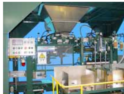
操作盤・充填部・給袋部
